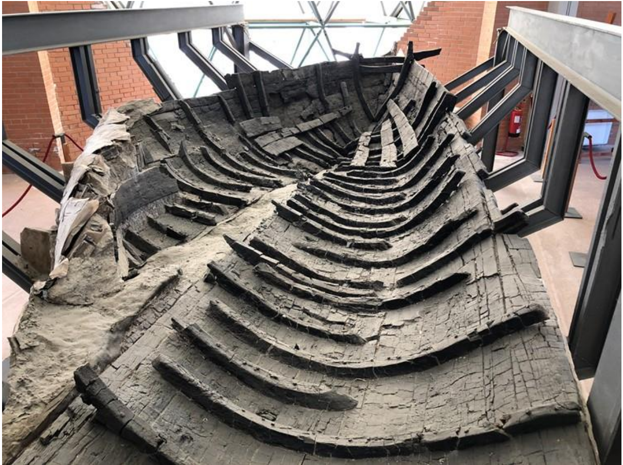
図 13 ヘルクラネウムから出土した釣り船。この船は軍用ではないが、この時代の船の基本構造は船殻を先に作り、そこに枠組みを釘やほぞ接ぎで組み込むというもので、その点では軍艦も同様だったと想定されている。Padiglione della Barca Romana 所蔵。筆者撮影。
