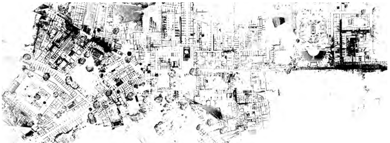
図3 3, 洪水のシミュレーション、シナリオB：広場北側まで冠水し、列柱廊が水面上に出ている場合 (黒く描かれている部分が水面上)
